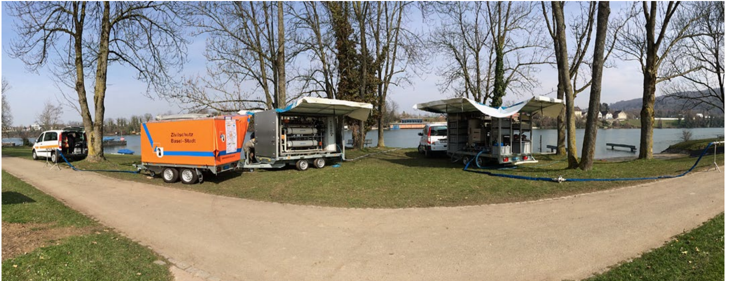
Eine mobile Aufbereitungsanlage produziert Trinkwasser für bis zu 40000 Personen.
