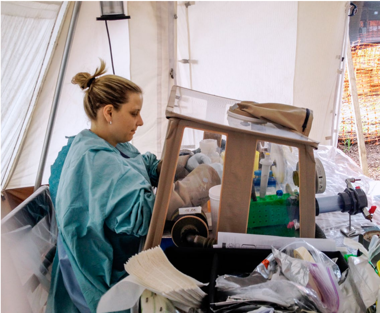
Die Mitarbeitenden des mobilen Labors schleusten die Patientenproben einzeln in die Glovebox, um sie chemisch zu inaktivieren.
